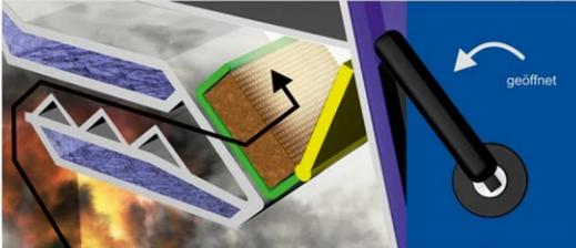
Ab einer Abgastemperatur von 250°C ist der Katalysator einsatzbereit. Die Bypassklappe wird geöffnet und die Abgase werden durch den Katalysator geführt. Eine chemische Reaktion bewirkt eine Nachverbrennung der Abgase.
